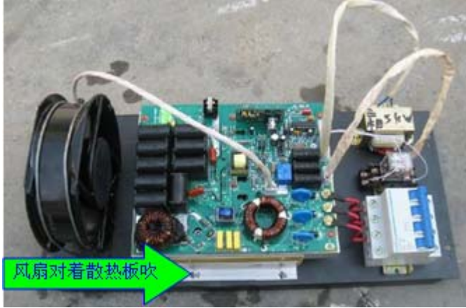
3.5KW~10KW 散热风扇安装方法
