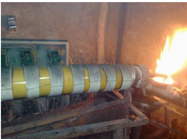
多个 5KW 组合在造粒机中的应用
