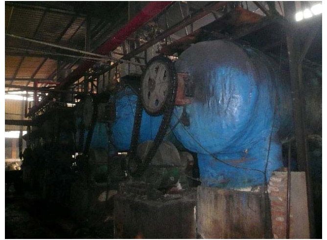
8 台全桥 20KW 与 5 台全桥 40KW 在大型废橡胶脱油罐中的应用
