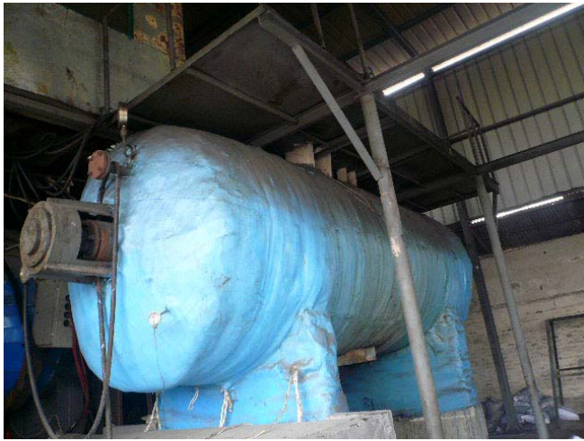
8 台全桥 20KW 与 5 台全桥 40KW 在大型废橡胶脱油罐中的应用
