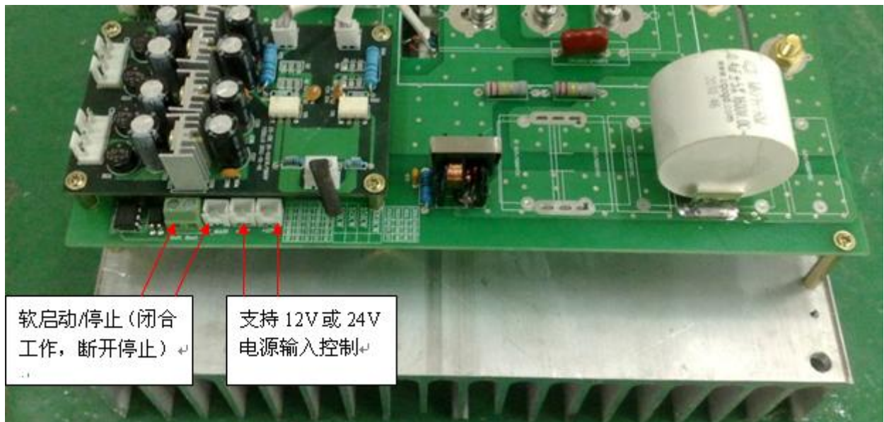
10KW/15KW 电路板式控制器结构示意图
