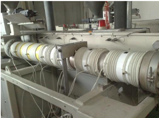
多个 10KW 和 5KW 在挤出机中的应用
