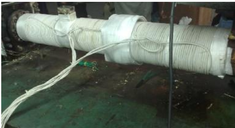
三台 10KW 组合在造粒机中的应用
