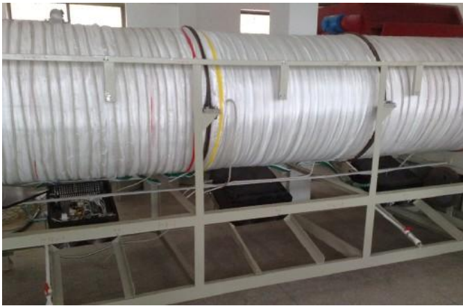
多个 40KW 在茶叶滚筒杀青设备中的应用
