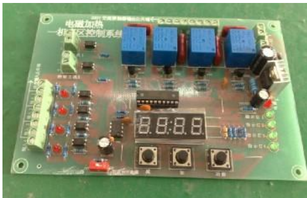
一机多区加热控制板（分区控制）
