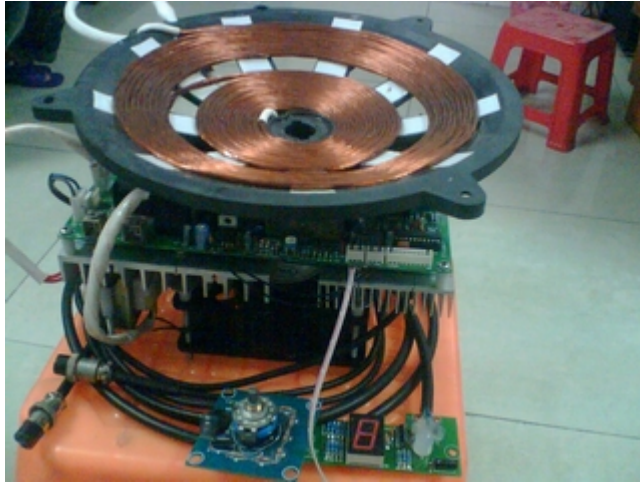
商用电磁炉应用实例
