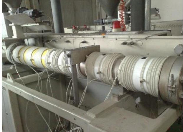
多个 10KW 和 5KW 在挤出机中的应用
