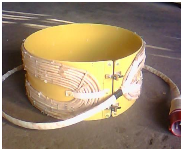
U形线圈（对扣式线圈）的制作案例
