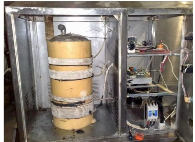
双 15KW 在工业炼油的的加热应用
