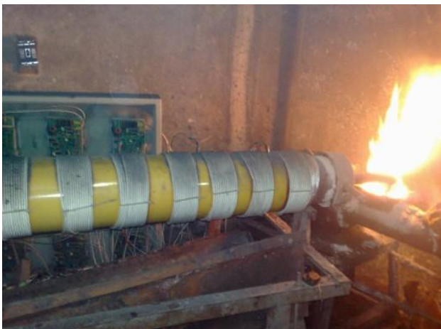
多个 5KW 组合在造粒机中的应用
