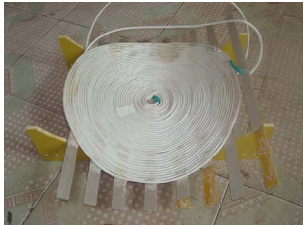
商用电磁炉线盘的制作案例
